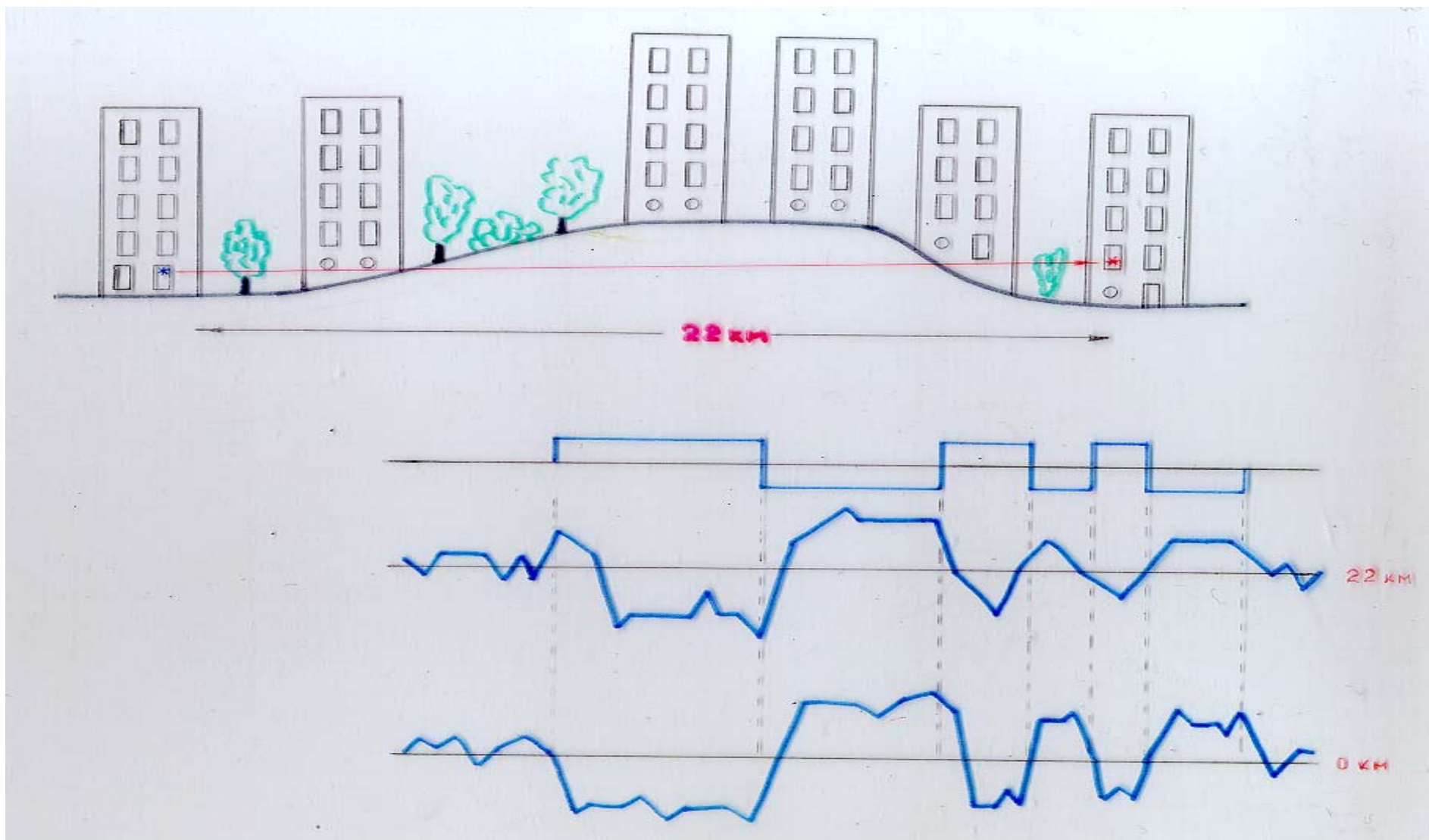
Рис.19А. Схема эксперимента и вид передаваемого и двух принимаемых сигналов в экспериментах в апреле 1986г.
